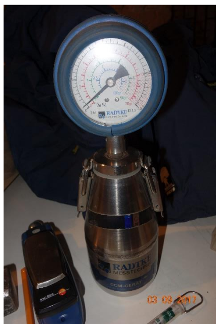
Il. 1. Sprzęt pomiarowy do oznaczenia wilgotności metodą karbidową
